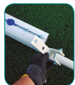
Colocación a base de poste
